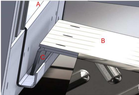
Die Halterung für die Rampe (A) wird am Containerboden mit den mitgelieferten Holzschrauben befestigt. Löcher müssen noch gebohrt werden.
